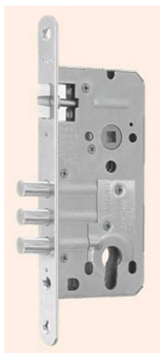
Брава GERDA ZW 1000 вкопана, секретна с шипове, със защитна планка и блокада, поцинкована с челна планка. Стоманата е обогатена с молибден, който увеличава здравината и устойчивостта срещу сплескване. Бравата се използва като основна за входни врати. Нейната конструкция и високо качество на компонентите гарантират дълго и надеждно опериране с нея. Притежава сертификат по европейски стандарт ENV
